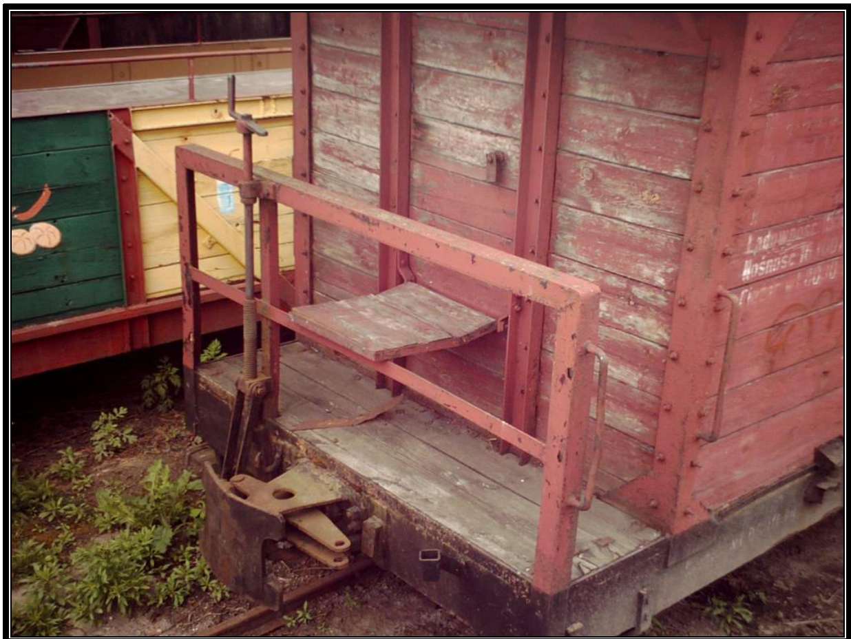
Pomost wagonu typu 72W z otwartym siedzeniem hamulcowego (PKP Kddx (błędne oznaczenie, powinno być Kddxh) nr 7276-0, przed remontem) stacja Środa Wlkp. Miasto, 2009 r., fot. Brood K.
